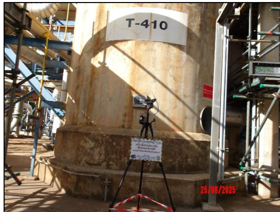
การตรวจวัดปริมาณฟอร์มัลดีไฮด์ บริเวณ Ethylene Oxide Purification (T-410)
